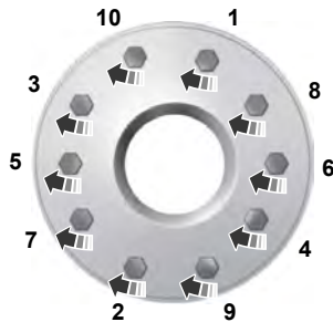
10-lug nut torque sequence
