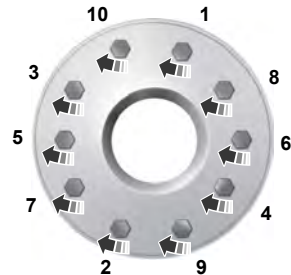
10-lug nut torque sequence
